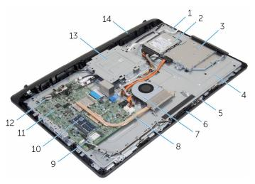
1 Ensamblaje de la unidad de Placa de los botones de control disco duró 3 Ensamblaje de la unidad óptica Base del ensamblaje de la pantalla 5 Placa del micrófono 6 Módulo de la cámara 7 el ventilador 8 Disipador de calor 9 10 Módulo de memoria Tarjeta inalámbrica 11 12 la placa base la batería de tipo botón
